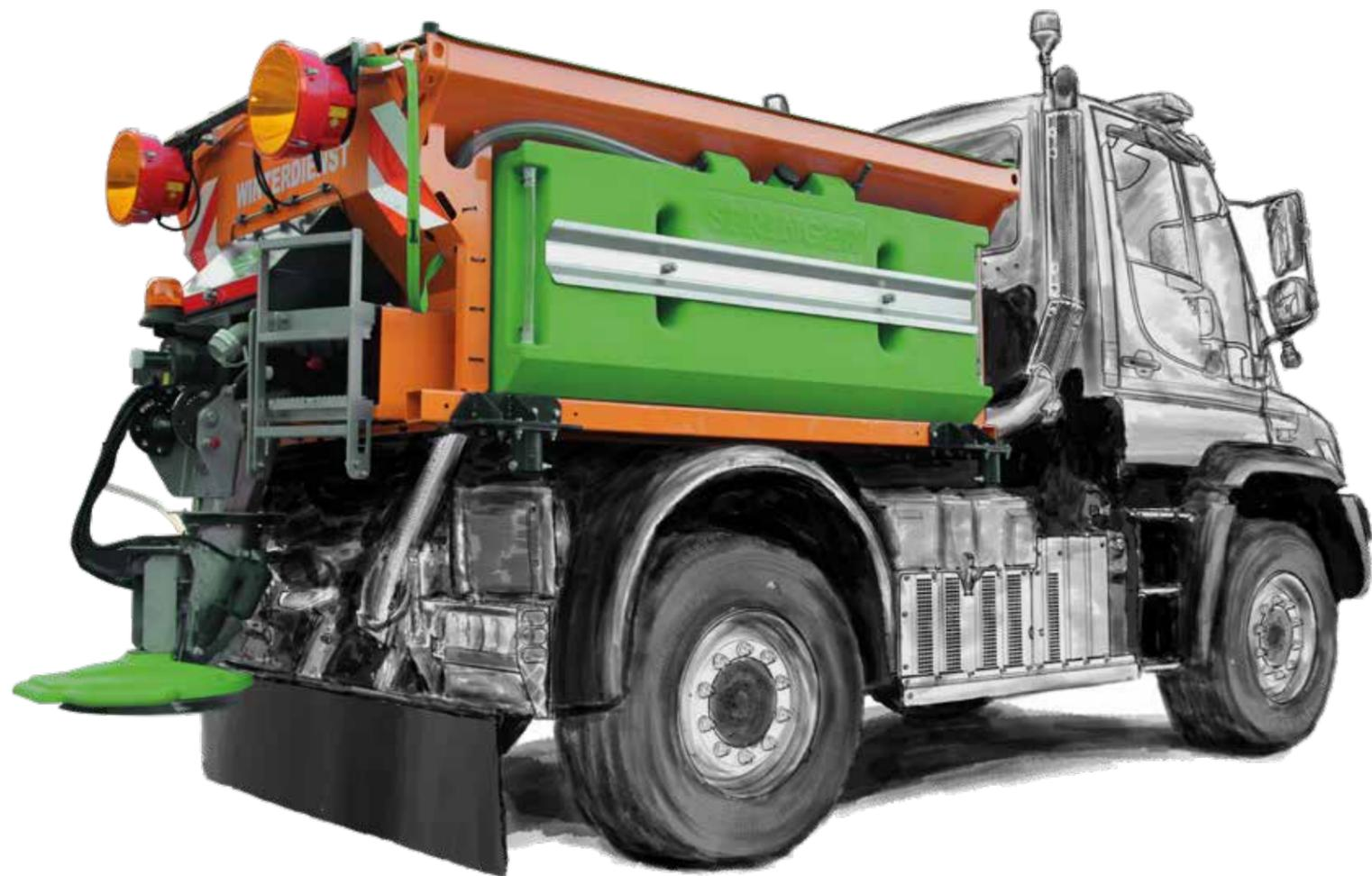
Der SPRINGER ASE ist ein Streuautomat mit Einschnecken-Förderanlage (optional auch als Doppelschnecken-Anlage) mit hohem Füllvolumen und ausgerichtet auf hohe Streubreiten von Trockensalz und Sole. Durch die innovative Streuteller-Streustoffrutschen-kombination ergibt sich ein ideal ausgerichte-
