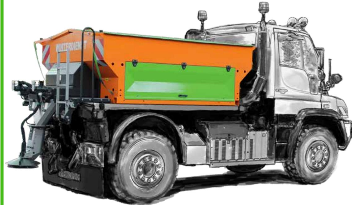
Die Streuautomaten der Serie AS 150 bis AS 280 decken das mittlere Bedarfssegment ab. Sie zeichnen sich durch eine höhere Zuladung und eine größere Streubreite aus. Die Kammern des Streuautomaten sind mit einer speziellen Lackierung versiegelt.
